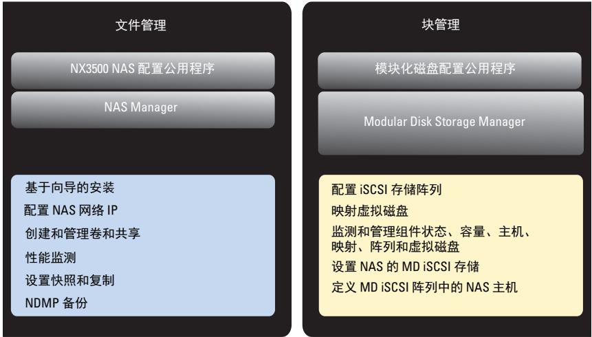
图 1-2. 文件级存储和块级存储
